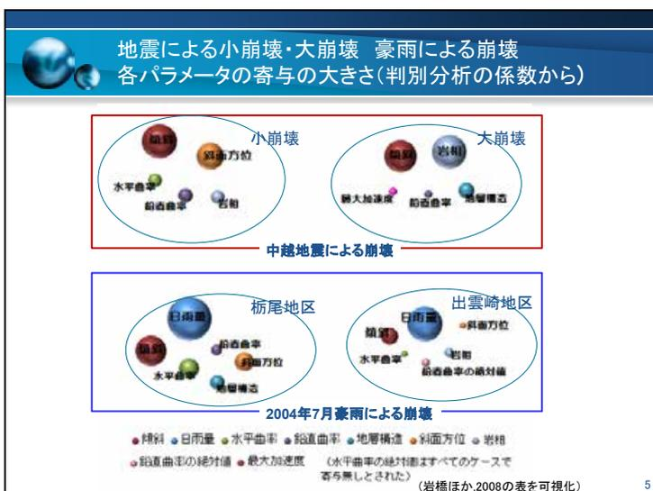
スライド5は、崩壊・非崩壊セルを目的変数、スライド2で挙げた項目を説明変数として判別分析を行った際に、正規化した係数の絶対値を求め、各パラメータの寄与の大きさを見積もったものである。分かりやすく円の大きさに表している。
