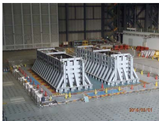
写真 7 土槽設置状況 17)
