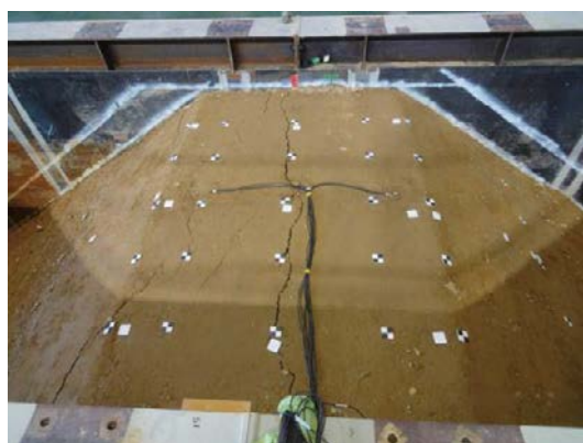
(a) 遮水シート工法の堤体天端
