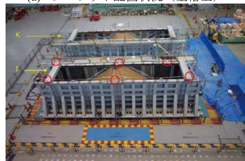
(b) 全体(手前土槽は遮水シート工法)
