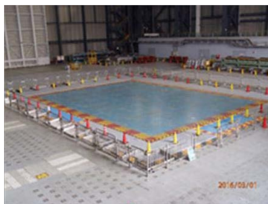
写真 5 実大三次元震動台
