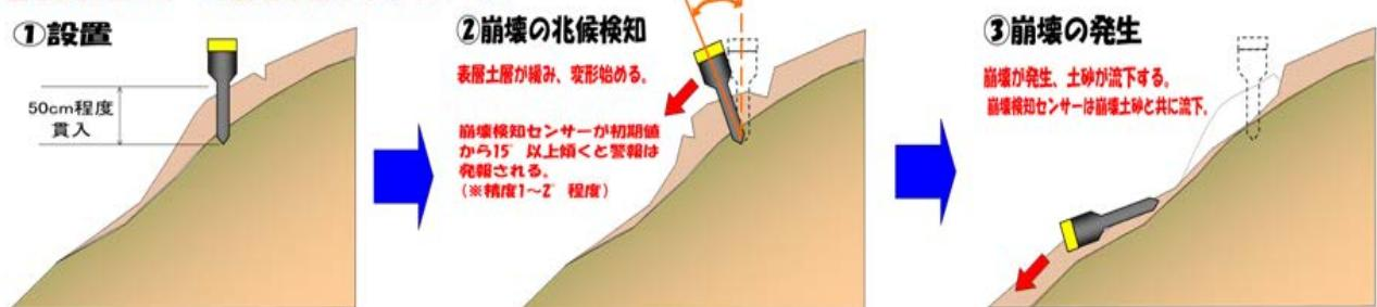
図1.2 崩壊検知センサー概要および検知イメージ図
