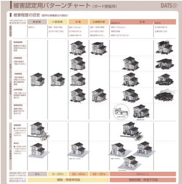
図 5.3.2-14 輪島市・柏崎市で利用された被害認定用パターンチャート(ボード壁面用)
