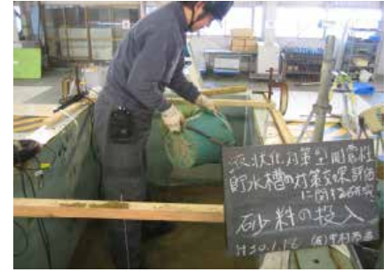
(c) 地盤材料の投入
