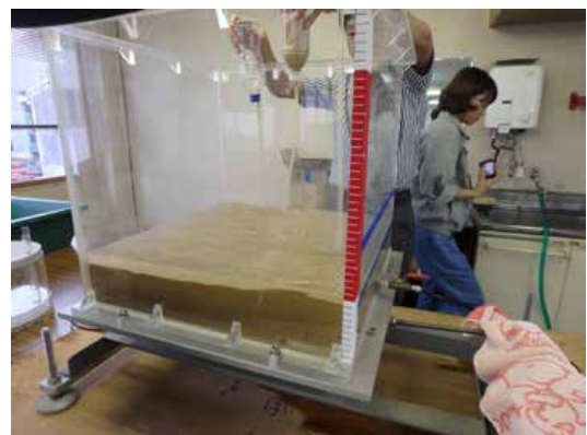
(f) 基礎地盤作製状況(2)
