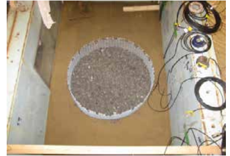
(f) 液状化対策用碎石籠
