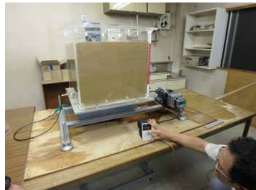
(n) 模型地盤および模型設置完了
