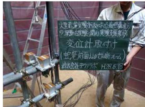
(l) 変位計設置(蛇籠および土槽)
