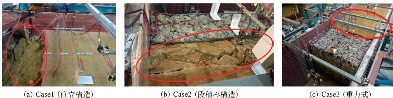
写真 27 加振後の背後地盤の損傷状況
