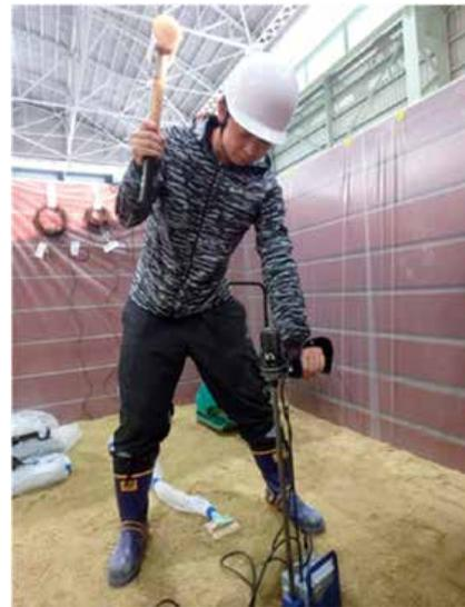
写真26 軽量簡易動的貫入試験実施状況
