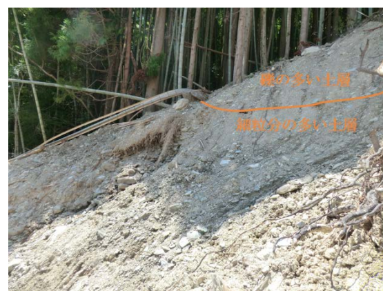
写真5 崩壊地側部を形成する崩積土層 Photo 5 Colluvium deposit at side of the landslide.
