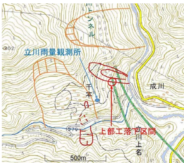
図1 本斜面周辺の地形 Fig. 1 Geomorphology around the landslide.
