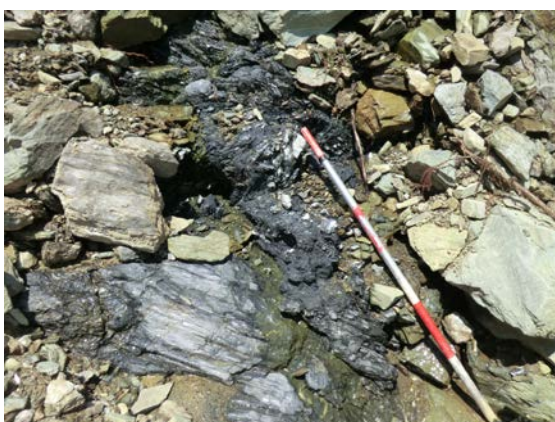
写真4 すべり面上の断層破碎帯粘土 Photo 4 Fault gauge on slip surface.
