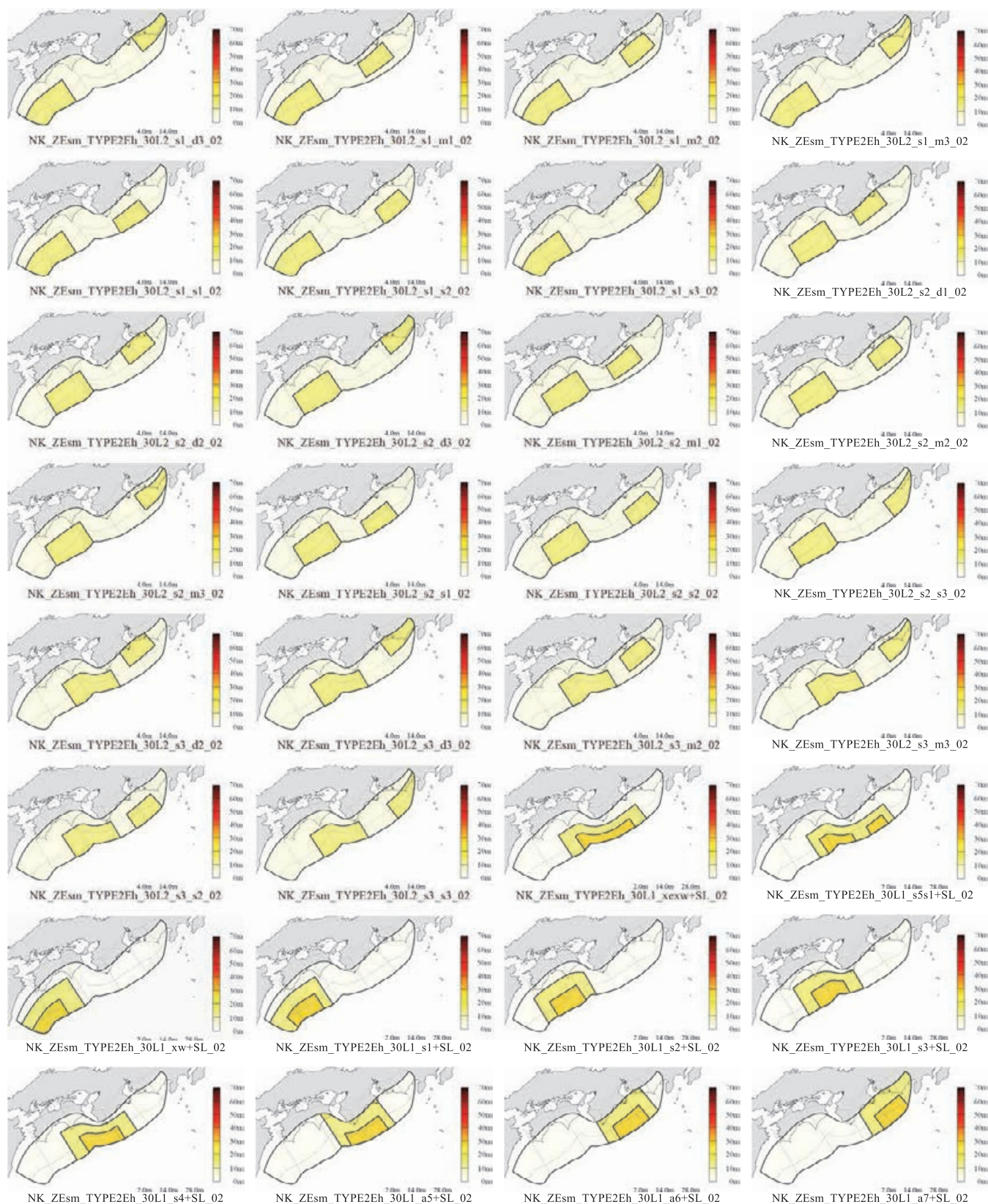
図 6.3.3-2 波源断層モデル図の一例(凡例はすべり量 (m) を示す, 震源域番号: 3, 震源域の位置: ZEsm) (3/4)
