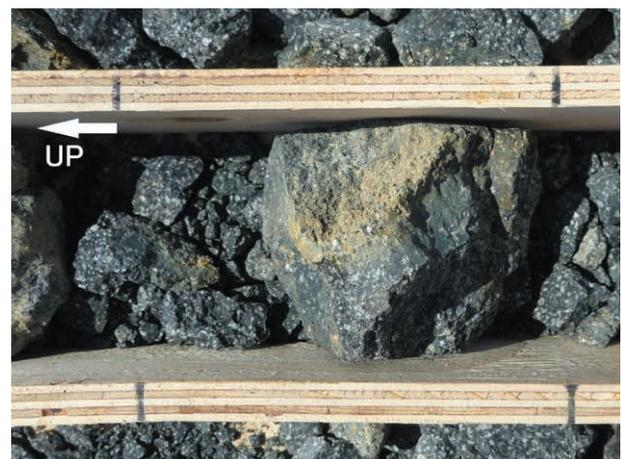
写真6 深度76.8m付近のガラス質な玄武岩質安山岩溶岩基底の破碎部
