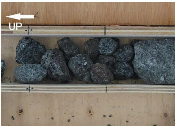
写真3 深度40.6mの赤色酸化したクリンカー礫.
