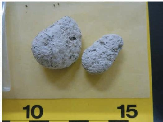
**写真 12** 深度 165 m 付近の円磨された軽石礫を含む火山礫凝灰岩層.
