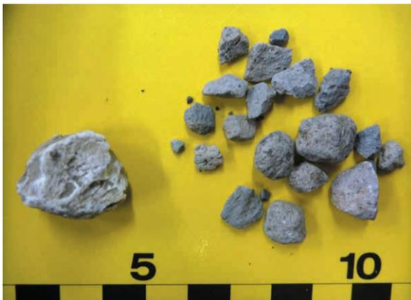
写真2 上部の深度14～22m付近に含まれる軽石礫(左:Us-bテフラに類似)とデイサイト質岩片(右).
