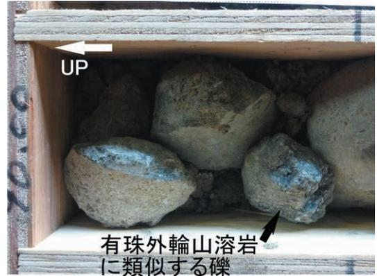
写真9 深度96.1 m付近の火山岩円礫。有珠外輪山溶岩類似の亜角礫を含む。
