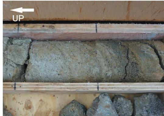
**写真 15** 深度 185 m 付近の成層した凝灰岩層.
