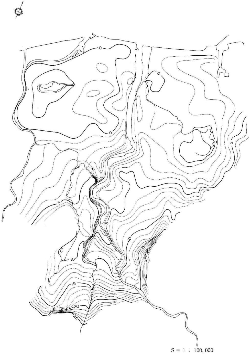
図7 阿賀野川地下水コンター図 昭和55年10月5日
