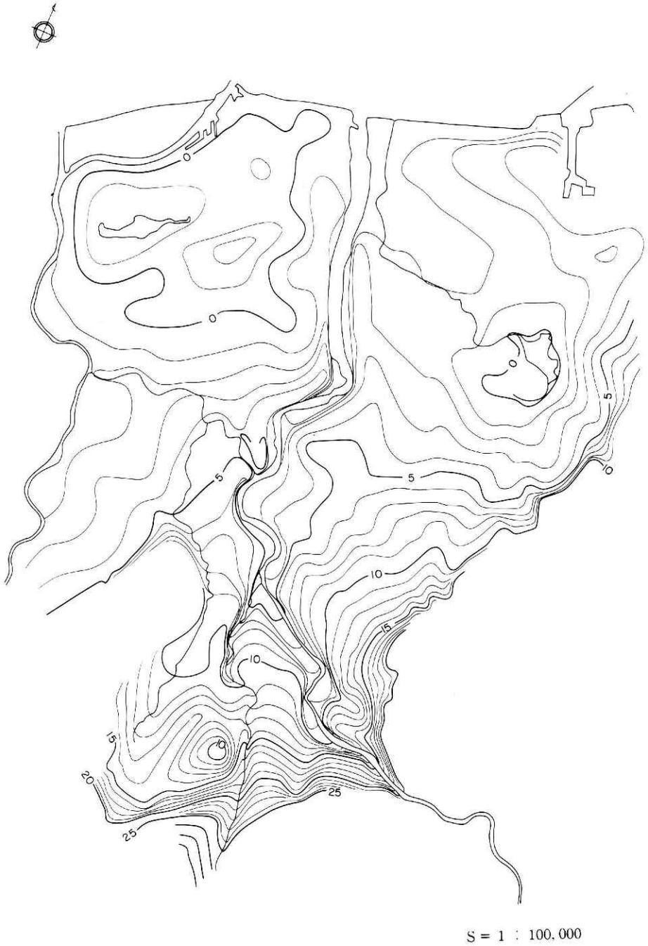
図11 阿賀野川地下水コンター図 昭和56年11月7日
