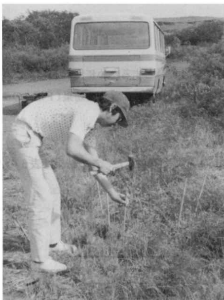
写真9 電極を群設置している様子 (左上に発電機が見える)
