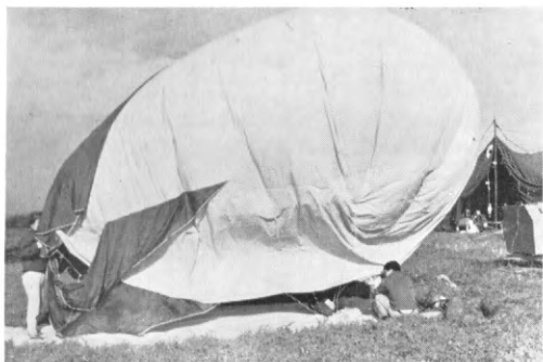
写真一Ⅱ けい留気球の水素ガス充填、 爆発性があるので作業は慎重に行なわれる
