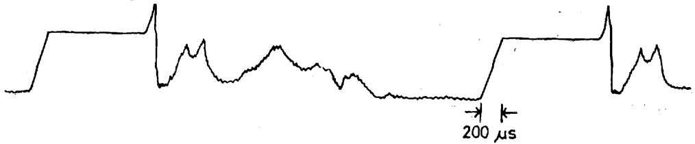
図-3 レーダー・エコー信号に台形の波形をのせたもの
