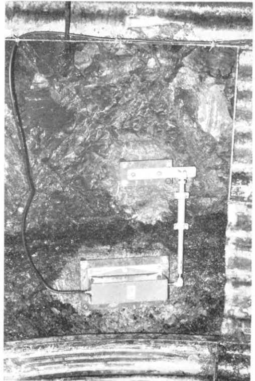
写真—3 試験井の炭層にとりつけたせん断変位計
