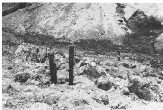
写真一三 崩壊地内崩積土上に設置された本器
