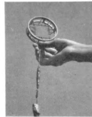
写真-7 白金抵抗線温度計の受感部。
