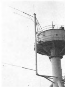
写真-5 海上観測塔に取りつけた風速計。
