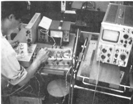
写真-8 波高計の特性試験中
