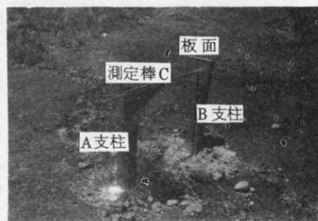
写真-2 測定中の断層変位簡易測定器
