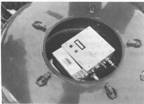
写真-1 水圧式ウェイブライダーの内部
