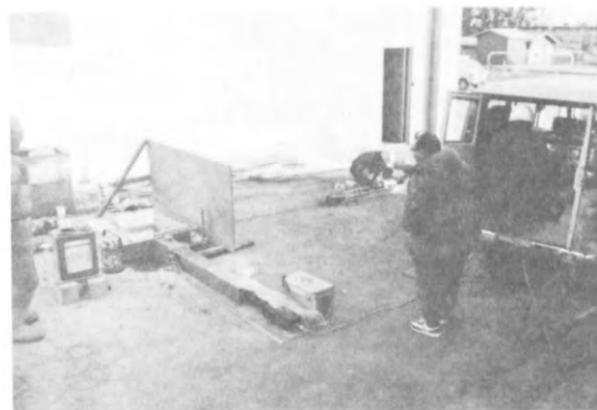
写真2 路面圧雪の引張式せん断はく離実験風景
