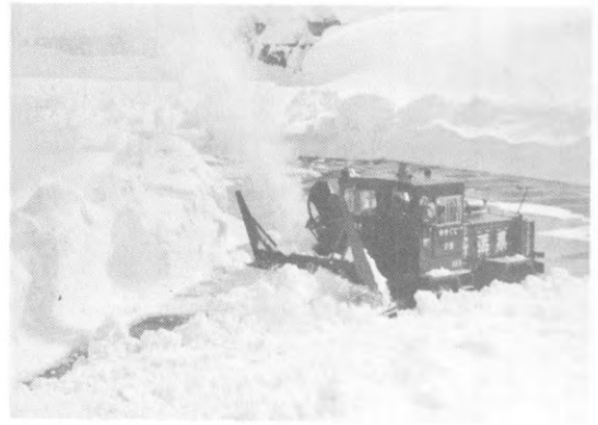
写真2 ロータリ除雪車による除雪
