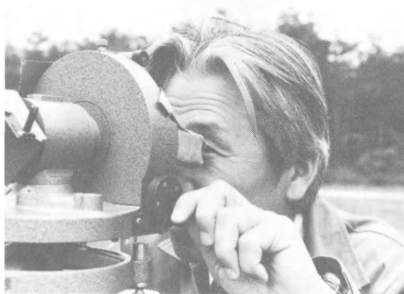
写真2 低層気象観測。風の測定のため、トランシットでラジオゾンデを追跡した。
