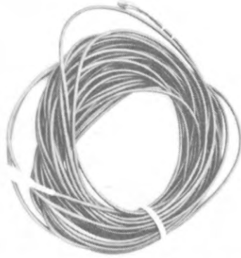
図1 ステンレス保護管付き白金抵抗体サーミスタ
