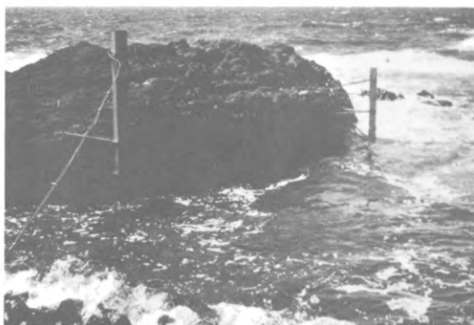
写真2 摺鉢山南端の飛石鼻に設置した潮位計、左手潮位計は、地殻変動のため地盤が隆起し、干潮時の水位を記録しなくなったので右手の位置に移設した。
