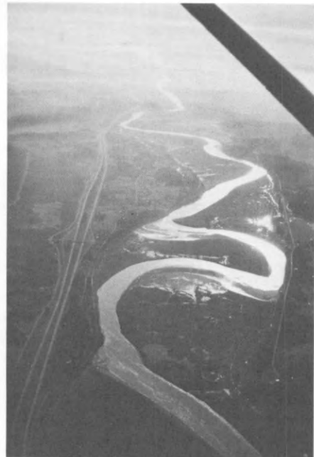
写真13 コウリッツ川を下流方向に望む。氾濫した土砂および川岸の侵食状況がわかる。左側はI5フリーウェイ。
