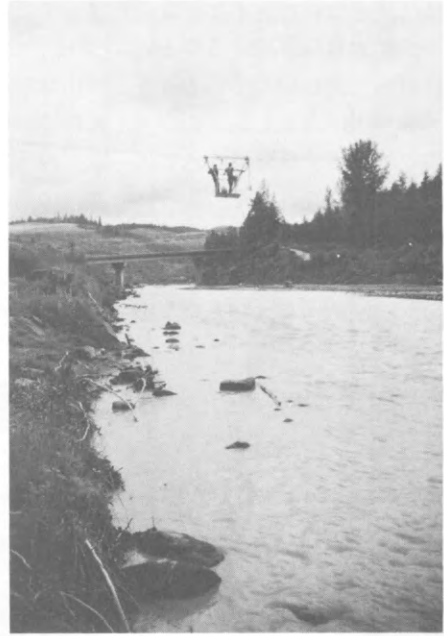
写真17 USGS によるタートル川での採水と 流量測定
