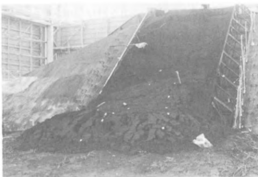
写真1 40°ローム模型斜面の崩壊
