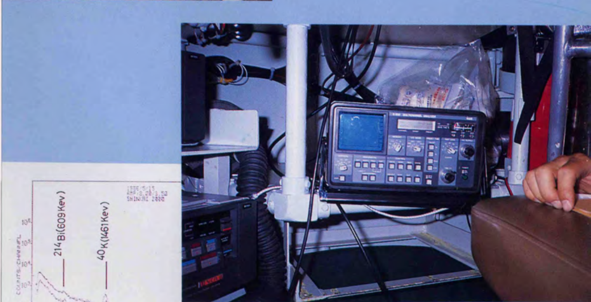
「しんかい2000」に設置されたポータブル型波高分析装置と海底ガンマ線スペクトル
