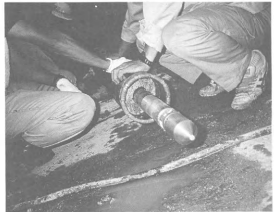
写真1 応力解放法による測定風景(筑波山にて、工業技術院公害資源研究所による)。オーバーコアリングした後、地上に測定器を回収したところ。中心部に突き出たものが孔径変化測定器、径の大きな管状のものがオーバーコアリングしたときのビット、その中に応力解放された岩石が見える。
