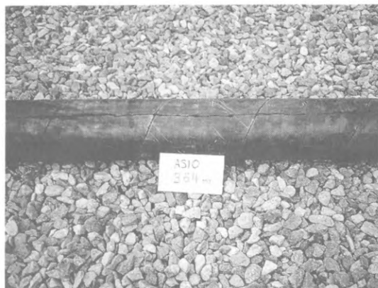
写真3 型どりパッカーにより得られた割れ目跡。型どりパッカーの直径は13cm（ボーリングの孔径は16cm）。長さ約2mの割れ目が1本見える。これと斜交している何本かのすじは、型をとるための塑性ゴムを巻いた継ぎ目。栃木県足尾花崗岩帯で、深度364mの水圧破壊で作られた割れ目。
