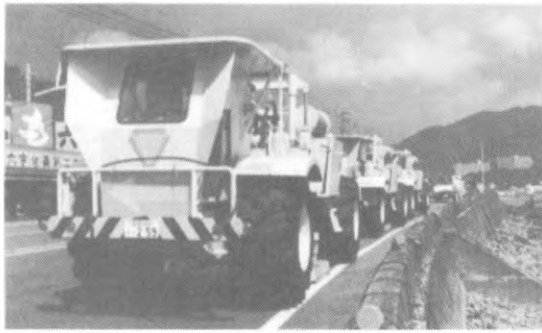
写真1 観測状況 (バイブレーターと地震計)
