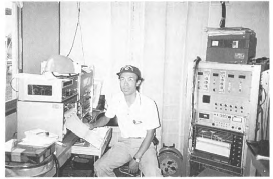
写真4 水圧破壊時の測定室内（人物は筆者）。背景の壁に、孔内状態を測定したさまざまな検層図が貼ってある。
