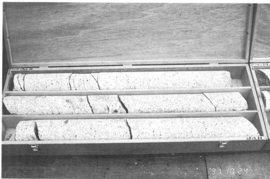
写真2 1913 m 付近で採取された岩石コア。直径 10 cm, 箱の長さは 1 m。亀裂はすべて採取時にできたものである。
