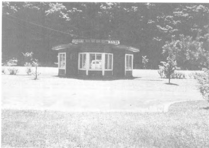
(c) TSI (大成町貝取潤) 小さな谷の真ん中に建てられた小屋のタイルの床面上に地震計を固定。
