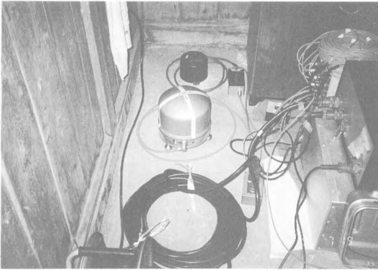
付図2 観測システムの写真。左手前が、広帯地域地震計 STS2, 左手奥が加速度計, 右手尉が PIAS100 (収録装置)。
