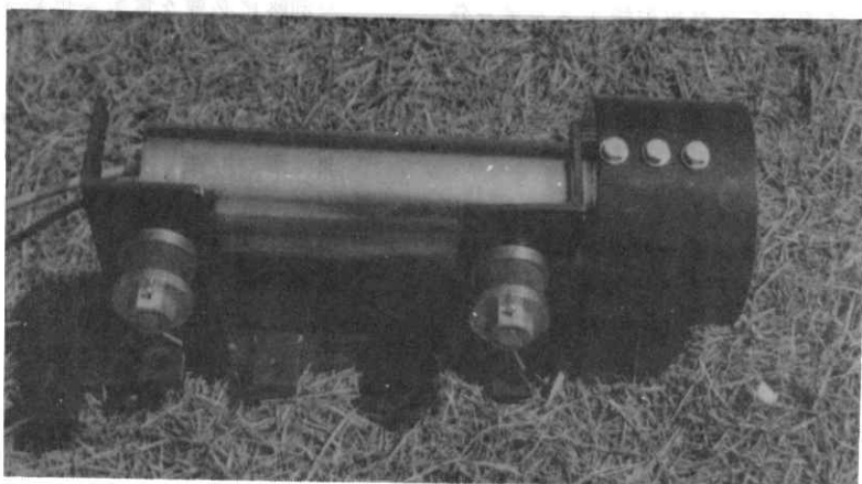
写真-2 宇宙線用シンチレーション検出器右側が鉛シールド
