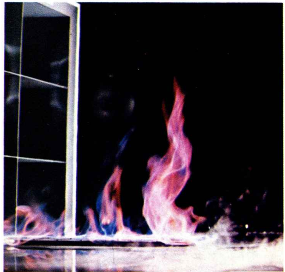
写真8 実験の際に生じた渦状の火柱（側面から撮ったもの）
