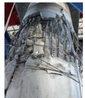
上段落とし部でせん断破壊した鉄筋コンクリート橋脚 RC pier with shear failure at the upper cut off area
