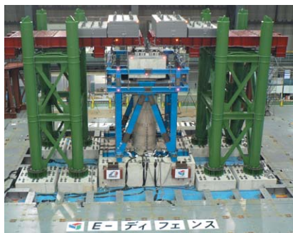
1970年代に建設されたRC橋脚（段落しない）を対象とした実験 Test of RC bridge piers constructed during the 1970s
