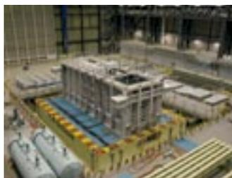
矢板護岸とその背後に杭基礎構造物を有する実大規模の地盤模型試験体。
